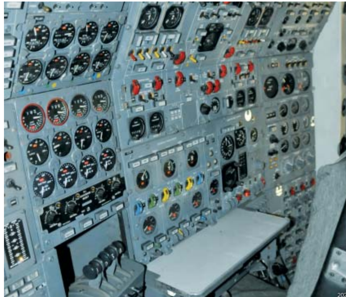
[202] F-WTSS, 2/03/2009, Paris-Le Bourget, musée de l'Air et de l'Espace. Le panneau de commandes du mécanicien navigant du prototype. The prototype's Flight Engineer's panel.
